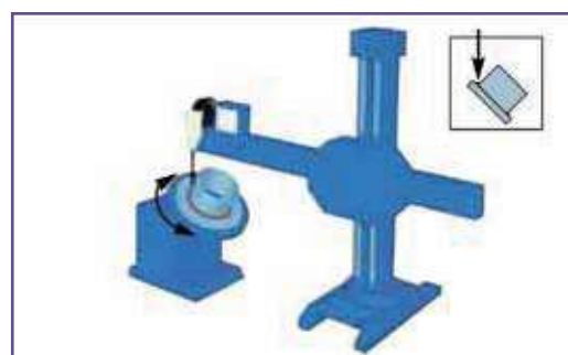
Saldatura su posizionatore a tavola rotante Welding on a positioning table Сварка совместно со сварочными вращателями Soudage sur un positionneur a table tournante Schweissen auf einem Drehtisch Soldadura en una mesa giratoria
