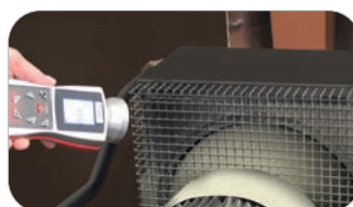
Stroboscopio spento: rotazioni non visibili
