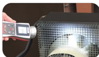
Stroboscopio acceso: rotazioni visibili
