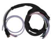
530361 (optional) Prolunga per carrello trainafile, 10 m con cavo in rame diam. 70 mm 2 predisposto per il raffreddamento ad acqua.
