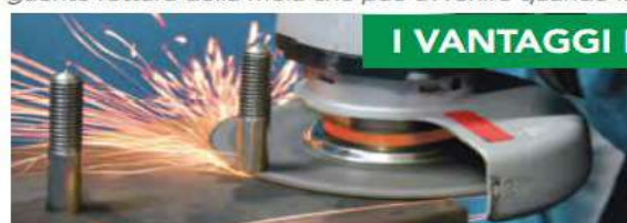
Taglio a raso possibile grazie alla conformazione a centro depresso unitamente all'uso dello "SPACER".
