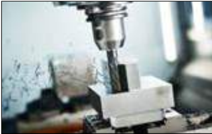
Fresatura di spallamenti
