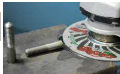
Taglio raso di prigionieri. Flush cutting of stud bolts.
