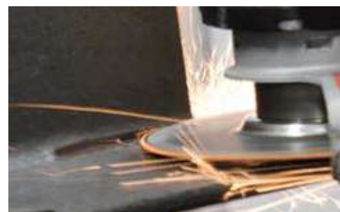
Taglio raso di profilo ad "H" in acciaio. Flush cutting of H-shaped steel sections.
